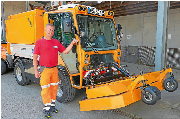
Michael Liedtke, Leiter des städtischen Bauhofs, mit einem neuen Fahrzeug, das sowohl im Sommer und Herbst für die Grünanlagenpflege als auch im Winter für den Winterdienst eingesetzt werden kann.
