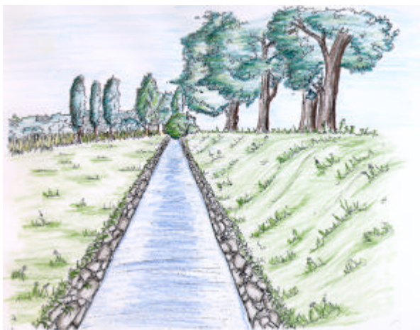
Abb. 7: Gewässer mit Uferbefestigung vor Umgestaltung
