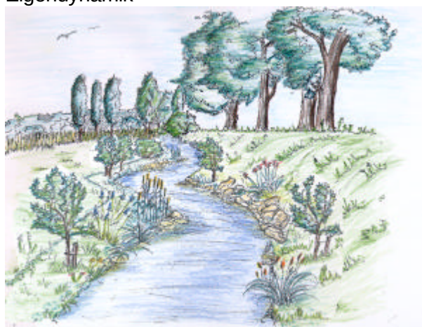
Abb. 8: Gewässer nach Entfernung des harten Uferbaus und Anregung der Eigendynamik
